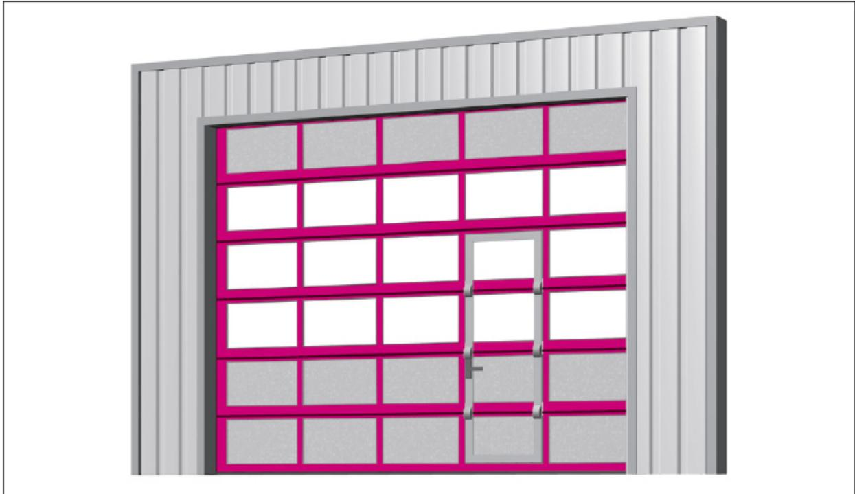
RSL-Tor mit Verglasung, Sandwichplatte 16 mm und integrierter Schlupftür
