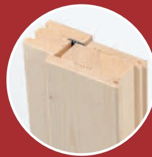
**Dreiseitig umlaufender Stockrahmen 78/ 68 mm, 3-fach lamelliert, B4 verleimt nach DIN 68602**
