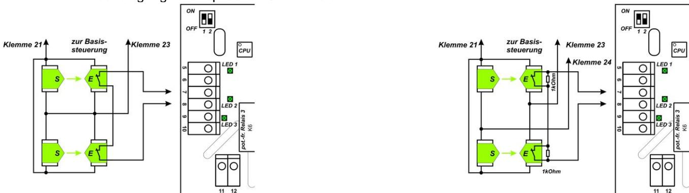
Anschlussbelegung von Lichtschranken ohne und mit Testfunktion
