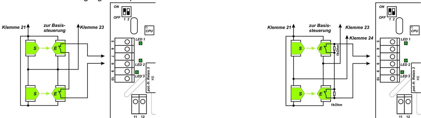
Anschlussbelegung von Lichtschranken ohne und mit Testfunktion
